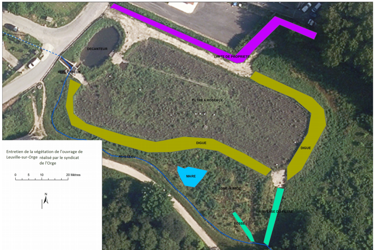
Illustration 3: Localisation des opérations d'entretien du filtre et de ses abords. Source Syndicat de l'Orge.
